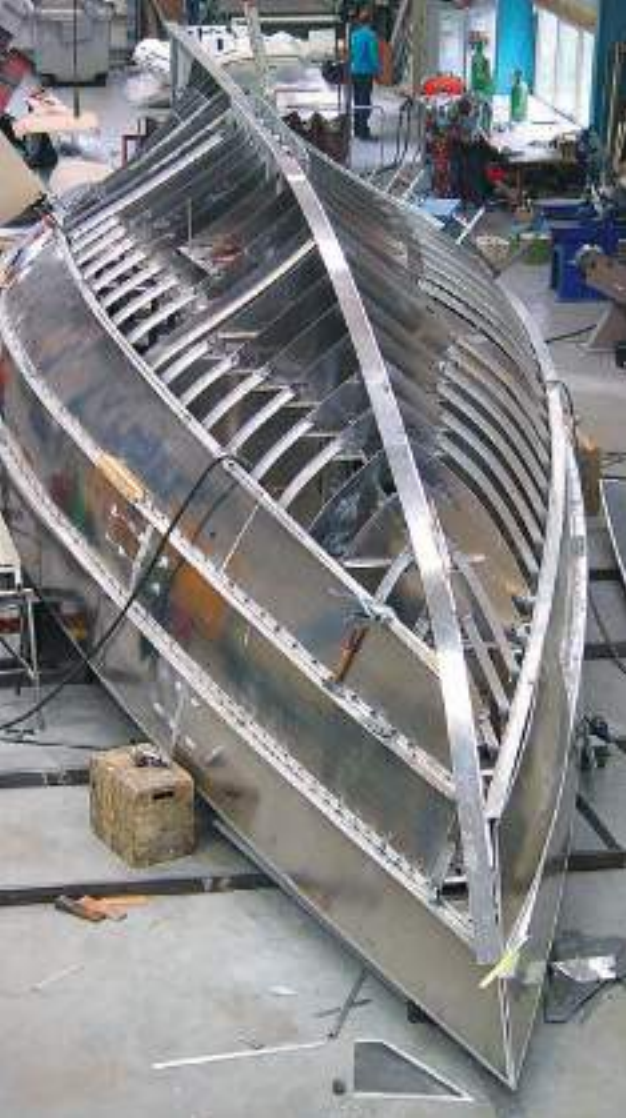
Eine Hutting 45 im Bau: Die Langkielyacht wird mit Hilfsstringern am Rumpf gefertigt und bleibt so in Form. Die Leisten werden abgeflext, die Schweißstellen geschliffen. Gut sichtbar: enger Spantabstand und starkes Kielschwein
