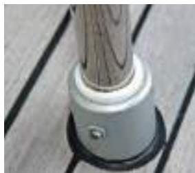
Isolierung 3: Aluhülse am Deck, Delrin-Einsatz und Edelstahl-Relingstütze. So muss es sein!
