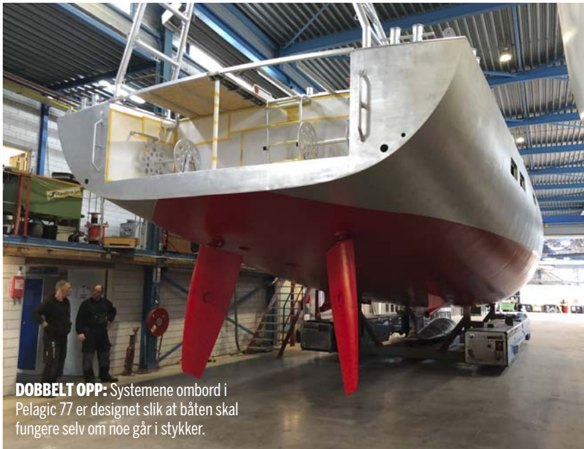
IKKE ISBRYTER: Skroget er i aluminium. Det er forsterket for å kunne operere i farvann med is.
