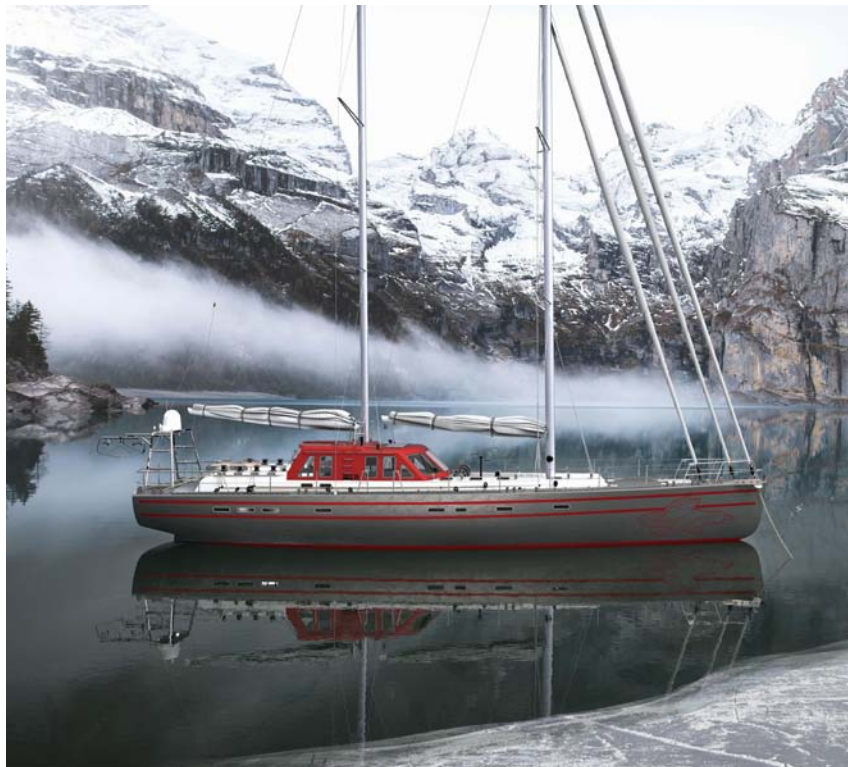
IKKE ISBRYTER: Skroget er i aluminium. Det er forsterket for å kunne operere i farvann med is.
