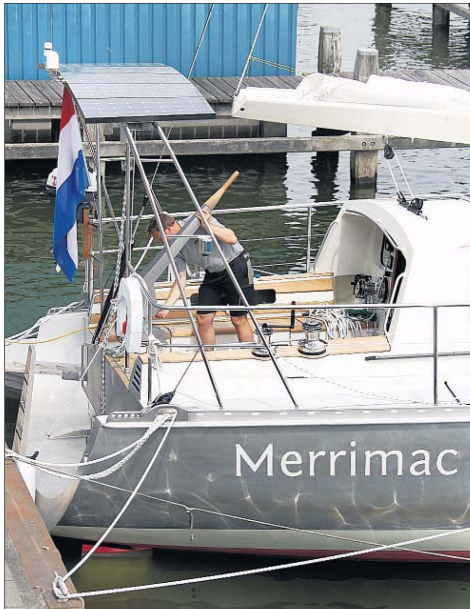
Kees Verruijt op het achterdek van zijn jacht, waarop het stuurwiel heeft plaatsgemaakt voor een helmhout. Op beugels op het achterdek zijn de zonnepanelen geplaatst. Rechtsboven: Een rail maakt het ononderbroken gebruik van de lifeline mogelijk. Rechtsboven: Verruijt kan op afstand diverse voorzieningen aan boord in- en uitschakelen.
